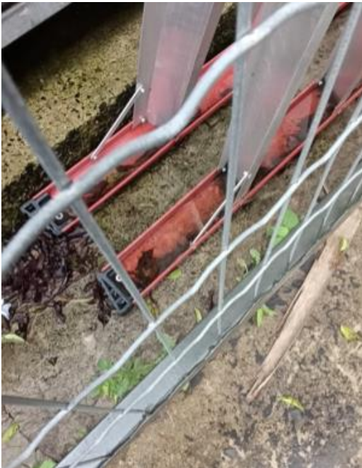
Equipamento e materiais na chuva. Escada de fibra danificada, suja e molhada. Pode causar choques elétricos se utilizada dessa forma. Risco de quedas: avaliar a qualidade da escada e verifica há quando tempo está ao relento (acúmulo de água e sujidades indicam que está há muito tempo nesse local)
